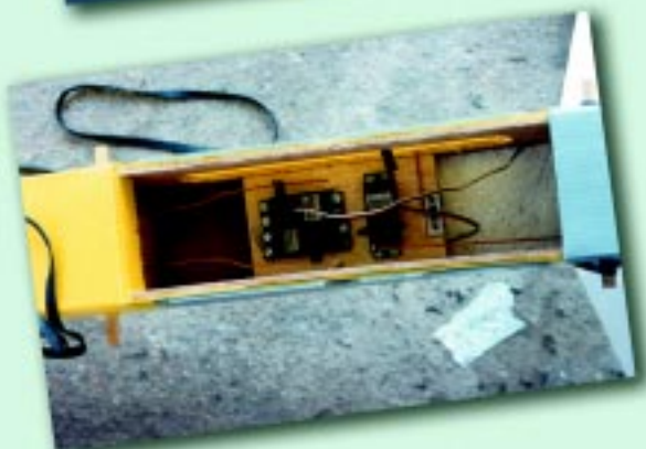
Do alto para baixo: o Pastinha em várias situações. Foto mais abaixo: instalação dos servos.
