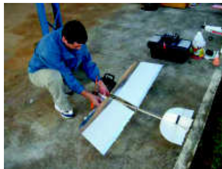
Demoiselle - O modelo da foto tem peso total de 250 gramas e área de asa de 18dm 2 . O que permite vôos tranquilos de 5 a 10km/h
